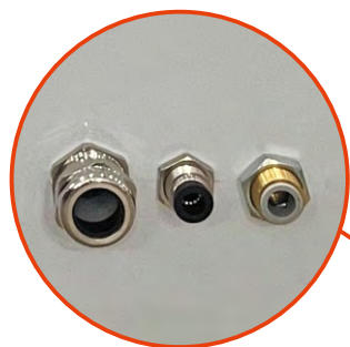
送钉管、电缆出口
