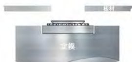
对正安装板材
