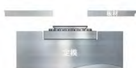
对正安装板材
